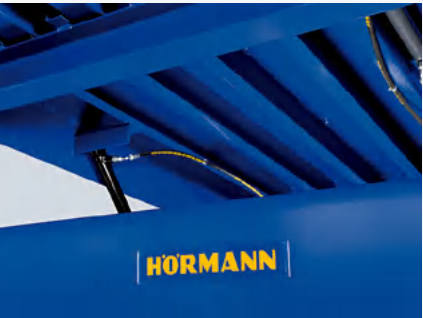
台面上方的加强筋设计 台面下方设计有多条加强筋，防止台面发生变形（车轮压痕），其数量和设计满足并超过 EN 1398 的要求。
